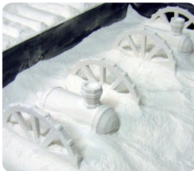
MOEF råder over avancerede 3D printere, der på baggrund af 3D data kan printe fysiske modeller ud i voks, plast og gips. Her ses en 3D printet prototype, der køler af i maskinen
