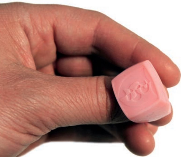
På baggrund af 3D data fremstilles 3D printede prototyper direkte i voks eller plast. Her ses en prototype af en ring, der er 3D-printet hos MOEF. Teknikken kaldes Rapid Prototyping (RPT)
